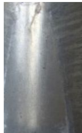
După 6 săptămâni de testare în mediu salin
