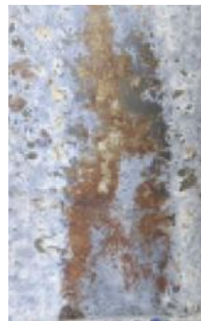
După 6 săptămâni de testare în mediu salin
